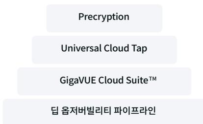
GigaVUE UCT는 가상 환경에서 가장 효율적인 통신 미러링 방법을 제공하도록 설계된 기본 Linux eBPF 기술을 활용하는 최신 가상 탭입니다. UCT는 암호화되지 않은 데이터를 수집한 다음 이를 Gigamon 딥 오피저빌리티 파이프라인에 효율적으로 전송합니다. 파이프라인에서 추가적인 최적화, 변환, 필터링 및 브로커링을 거쳐 궁극적으로 올바른 물리/가상 도구에 올바른 데이터가 전달됩니다.
