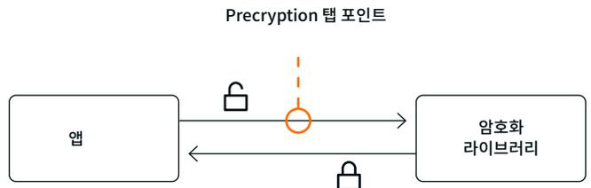
Precryption은 이러한 방식으로 암호화 전 또는 복호화 후에 네트워크 트래픽을 평문 형식으로 수집합니다. Precryption의 기능은 메시지의 실제 암호화나 네트워크 전송을 방해하지 않습니다. 또한 프록시, 재전송, 복호화 및 암호화의 반복(break-and-inspect)이 필요하지 않습니다. 대신 이 평문 사본은 [Gigamon 딥 옵저버빌리티 파이프라인](#)으로 전달되어 추가적인 최적화, 변환, 복제를 거치거나 다양한 도구로 전송됩니다.
